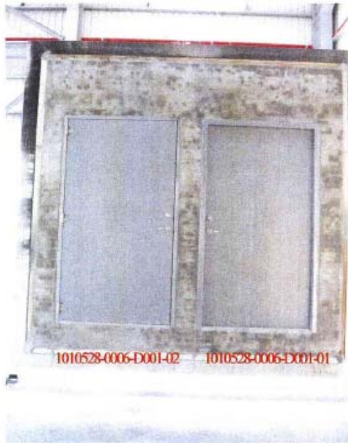
照片 2 加熱前試驗件加熱面
