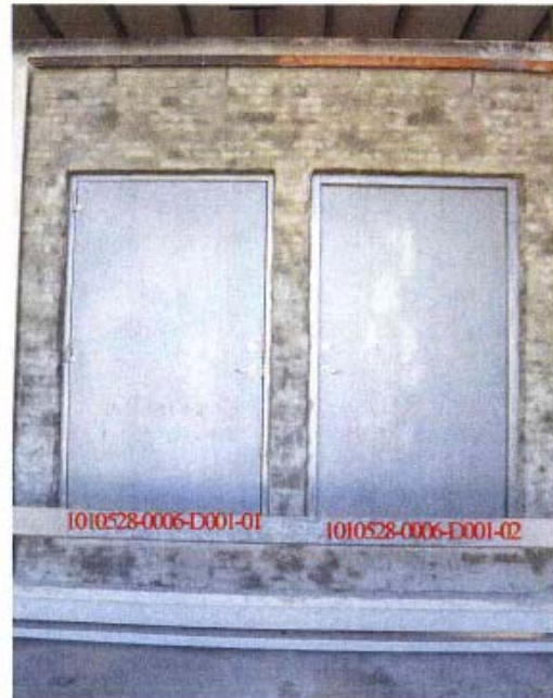
照片 3 加熱前試驗件非加熱面
