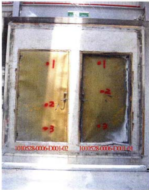
照片 6 衝擊後試驗件加熱面
