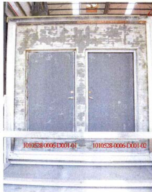
照片 7 衝擊後試驗件非加熱面
