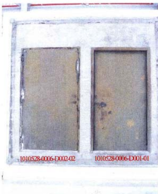
照片 4 加熱後試驗件加熱面
