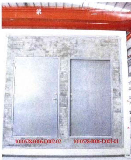
照片 2 加熱前試驗件加熱面
