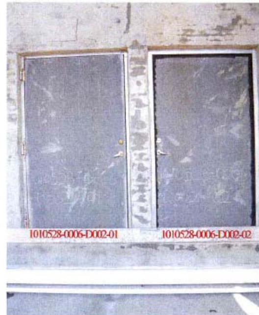
照片 7 衝擊後試驗件非加熱面
