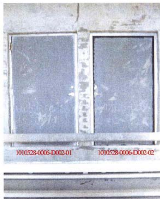
照片 5 加熱後試驗件非加熱面
