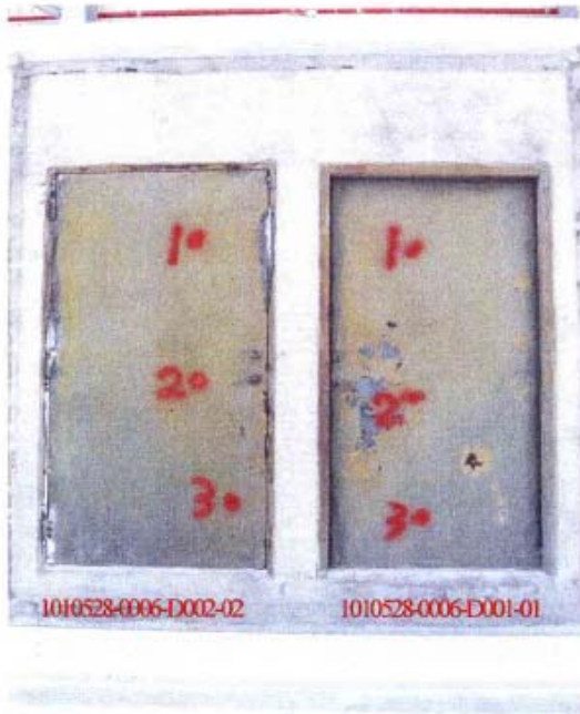
照片 6 衝擊後試驗件加熱面
