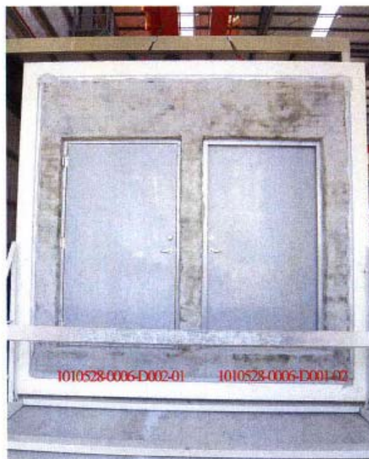
照片 3 加熱前試驗件非加熱面
